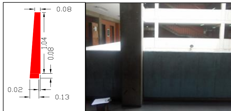
Figura 4.11.6.- Sección transversal del muro de concreto y fotografía del mismo haciendo referencia a la poca separación de la columna.
