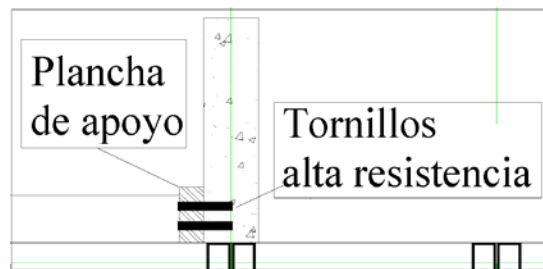
Figura 4.19.27. Opción 1. Detalle nodo de unión de sistema para garantizar diafragma rígido.
